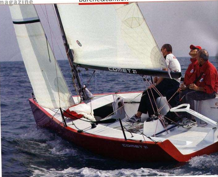
Sopra, il Comet 21 Open disegnato per Comar Yachts da Sergio Lupoli Yacht Design. Lo scafo è lungo 6,20 metri e largo 2,40. In assetto di stazza (con chiglia, timone, attrezzatura e cime) ha un peso minimo di 550 kg. La chiglia retrabile ne facilita il trasporto su un carrello monoasse. A destra, il timone in carbonio, estraibile.
